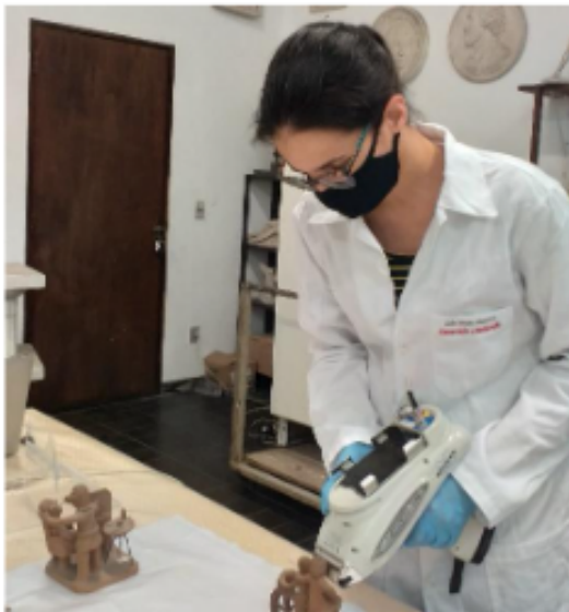
Fig. 8. Análises por FRX utilizando o equipamento portátil TRACER IV da Bruker®. Benvinda Ribeiro, 2020.
