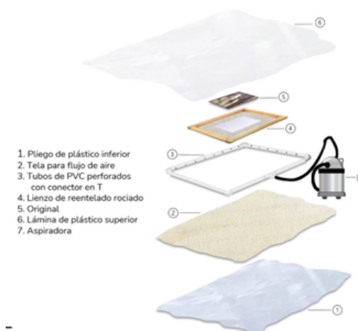
Fig.5. Componentes de la envoltura de baja presión del Mist-Lining. Imagen: Diana Paola Herrera Peña, 2025.
