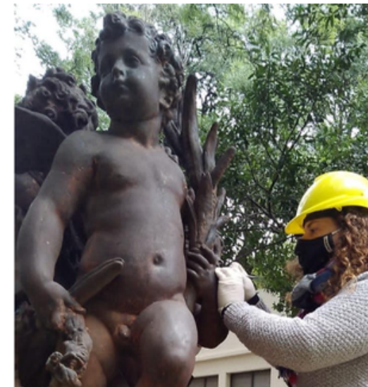
Fig.2 – Equipo multidisciplinar científico. Toma de muestras de capa pictórica para estudios EDX y SEM. Lic. Milagros Córdova del Instituto Nacional de Tecnología Industrial (INTI). Escultura “Grupo Versailles”, fundición de hierro pintada, fundidora Val d’Osne. Circa 1900. Fuente: Vilma Pérez-Casalet, 2022.
