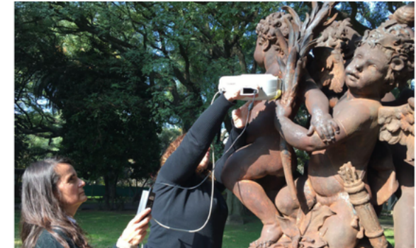
Fig.3 – Métodos no invasivos para estudios de metales. Aplicación de Fluorescencia de RX para la obtención de datos superficiales sobre aleaciones metálicas, Equipo del Centro Materia UNTREF. Dra.Eugenia Tomasini .Fuente: Vilma Pérez-Casalet, 2022.
